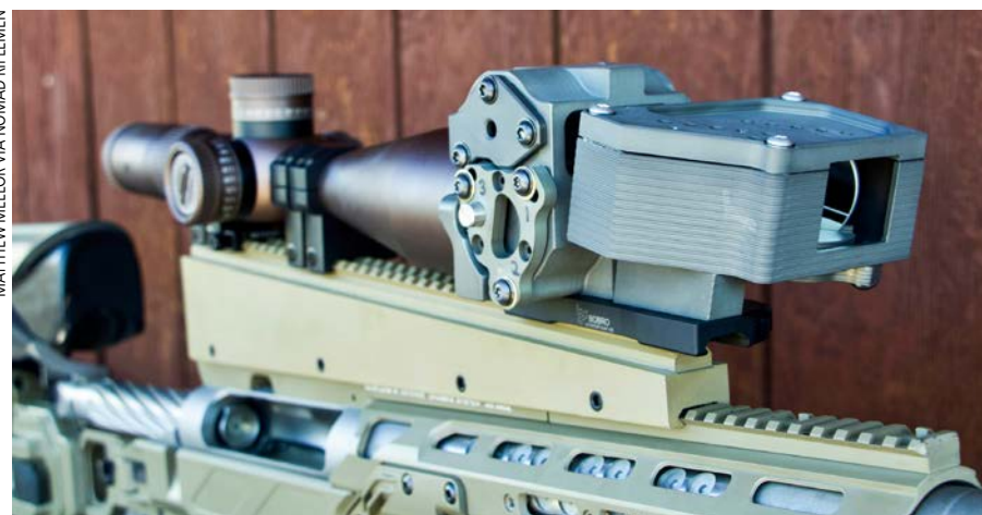
Żaden pocisk z żadnego karabinu nie trafi w cel bez dobrego celownika. Do rekordowego strzału posłużył Vortex Razor 6-35x56 FFP z siatką EBR-7D MOA na podstawie S&S Sporting 350 MOA z pierścieniami Leupolda i dwoma peryskopami przyzmatycznymi Charlie TARAC i Delta TARAC firmy tacomhq, koniecznymi do uzyskania kolejnych 700 MOA zakresu regulacji – i w ogóle uzyskania w okularze obrazu ponad wysoko zadartym wylotem!
